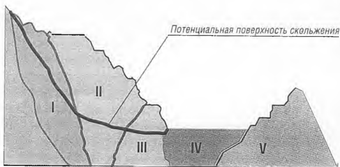
Подобласть I – зона простираения крупнозернистой гранитной структуры; Подобласть II – зона простираения известняка мраморизованного; Подобласть III – зона простираения гранитов-порфиров; Подобласть IV – имеет структуру мраморной брекчии. Подобласть V – известняка мраморизованного.
